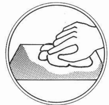
Essuyage de la surface après étamage.
