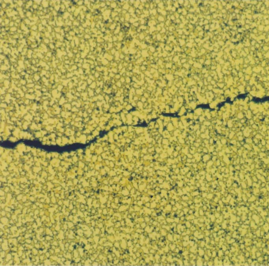
G 100. Fissuration inter cristalline de "crique saisonnière" dans un laiton CuZn40Pb3 (Centre de Recherches - Tréfinmétaux).
