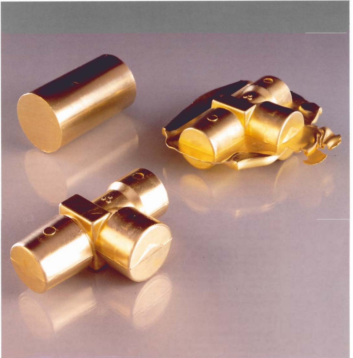
Robinet à gaz - Lopin, ébauche et robinet après ébavurage. Entreprise : S.M.T. Groupe CO2-21110 GENLIS
